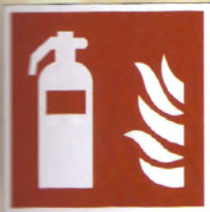
Feuerlöscher (ASR A1.3)
