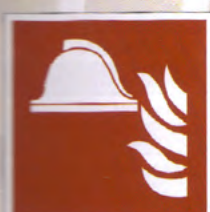
Mittel und Geräte zur Brandbekämpfung (ASR A1.3)
